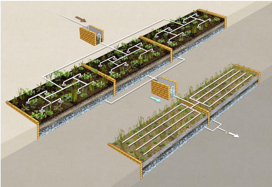
**Figura 5.1 – Esquema de um wetland vertical – Sistema Francês tradicional: três unidades no primeiro estágio e duas unidades no segundo estágio.**
